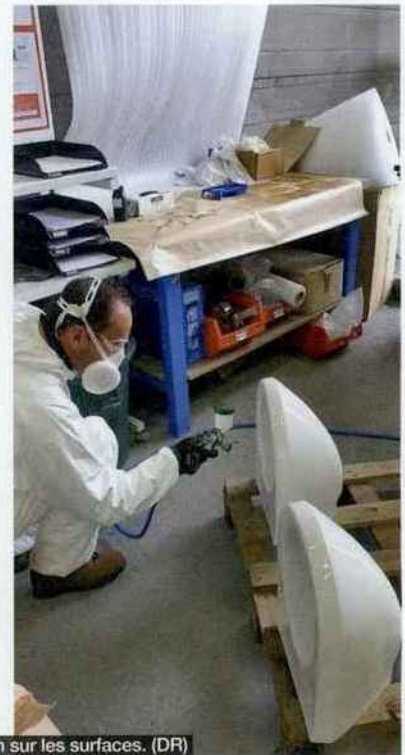
L'application de la solution se fait par micro-pulvérisation sur les surfaces. (DR)
